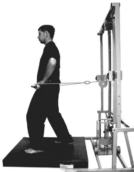
Slika 1. Sistem za vodoravno obremenitev in razbremenitev
